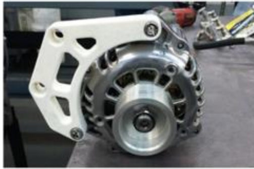
Slika 2. 29. – Funkcionalni nosač alternatora tiskan pomoću SLS najlona [23]
