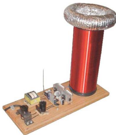
Slika 3. 3. - Teslina zavojnica s čvrstim stanjem (izvor: https://www.electronixandmore.com/projects/tesla/medsstc.html )
