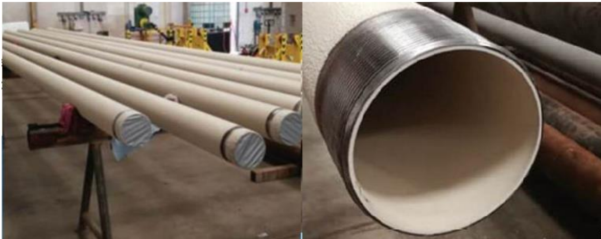
Slika 5.11 Primjer cijevi obložene poli-staklenim premazom [24]
