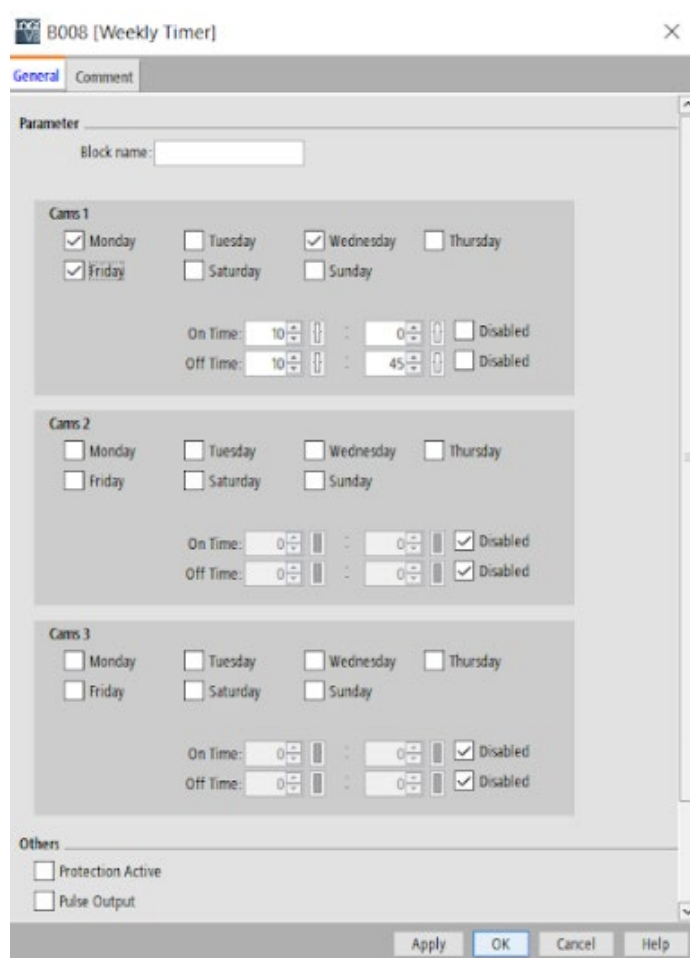
Slika 5.13 - Primjer vremenske automatizacije rada peći
