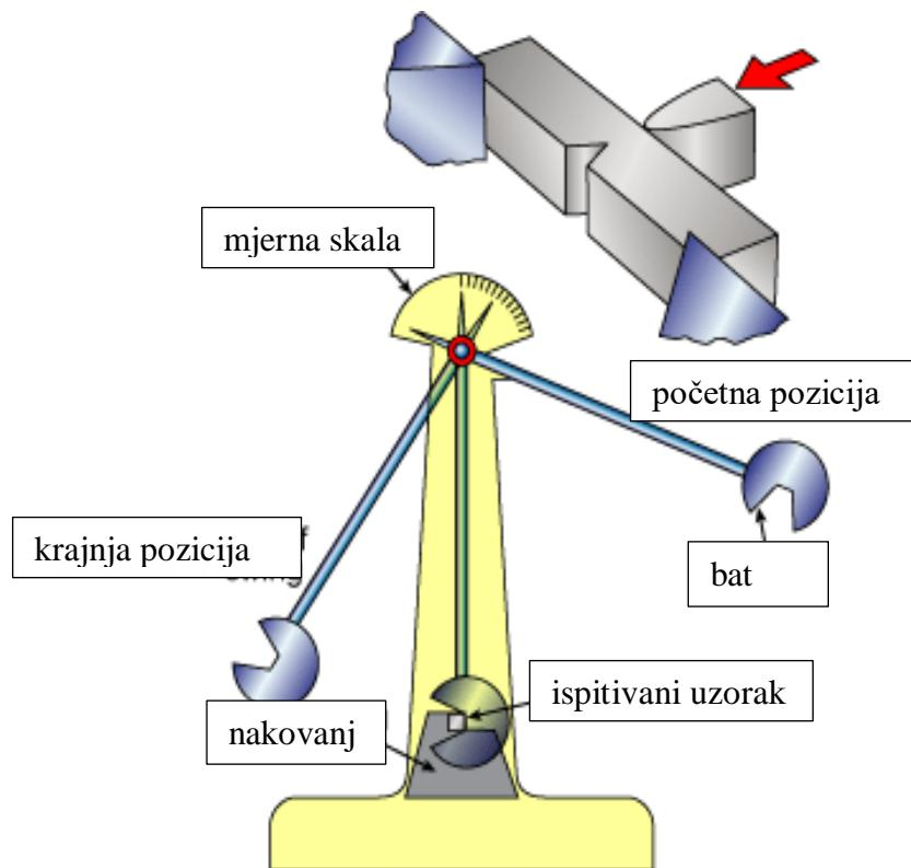
Slika 1.3 Uređaj za ispitivanje žilavosti po Charpy [3]
