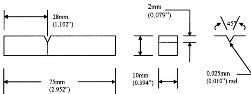
Slika 1.5 Dimenzije epruveta za ispitivanje žilavosti po Izodu [1]
