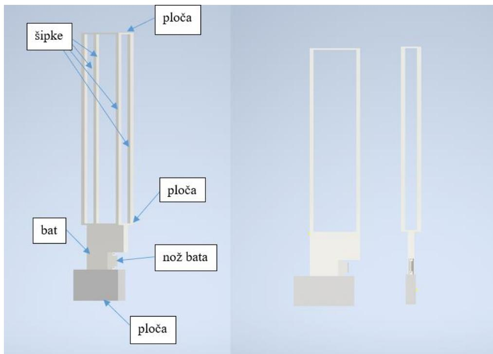
Slika 3.2 3D model rekonstruiranog pokretljivog dijela Charpy-jevog bata [5]
