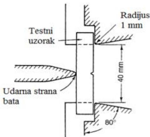
*Slika 1.4 Pozicija ispitivanog uzorka, epruvete na Charpy bat [1]*
