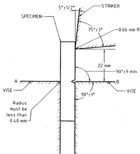
Slika 1.6 Način učvršćivanja epruvete za ispitivanje po Izodu [1]
