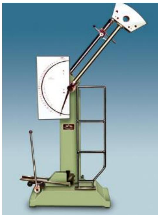
*Slika 1.7 Prikaz Izodovog uređaja za ispitivanje žilavosti [4]*
