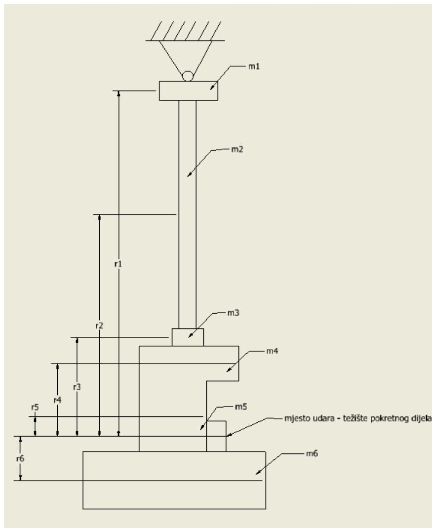
Slika 4.1 Pojednostavljeni prikaz pokretnog dijela Charpy bata [5]
