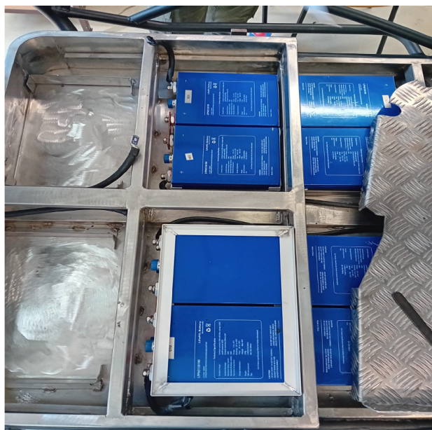
Slika 3.1. Prikaz ugradnje baterija
