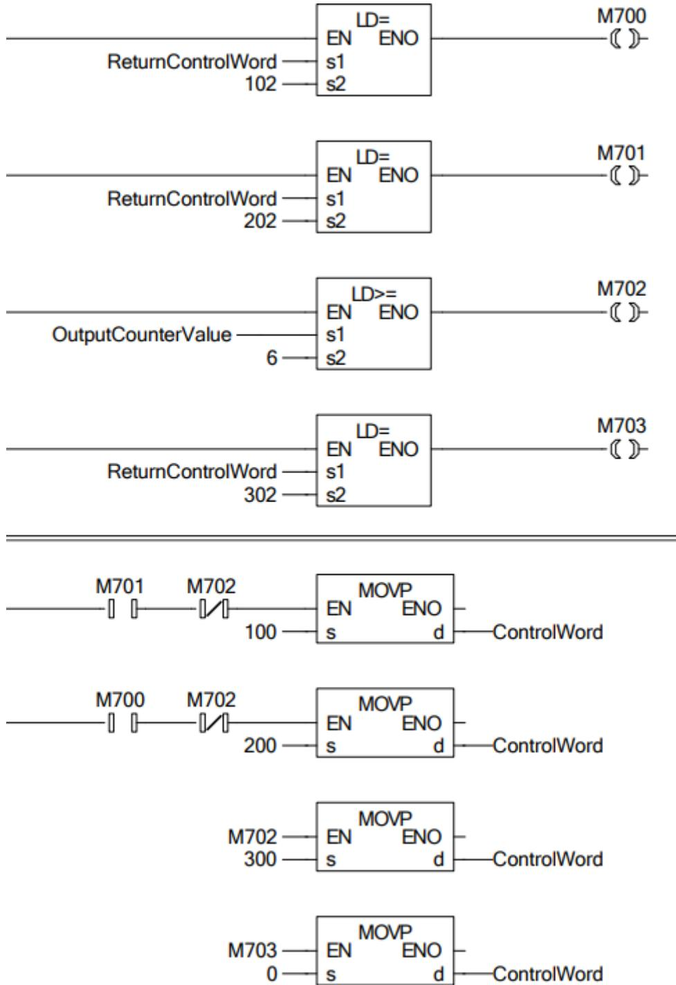
Slika 3.3 Upravljanje robot programima pomoću PLC-a
