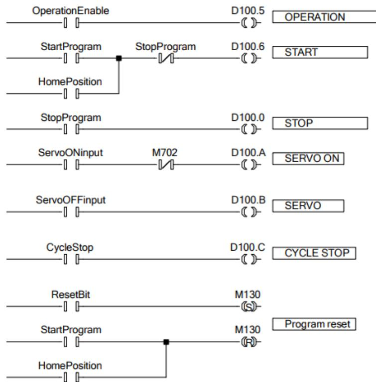
Slika 3.11 Ulazni signali robota
