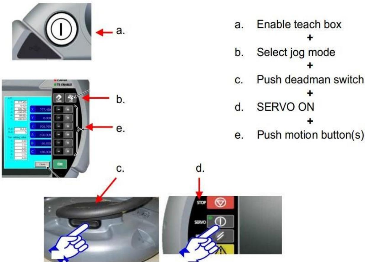
Slika 2.8 Postupak pokretanja robota pomoću TB-a
