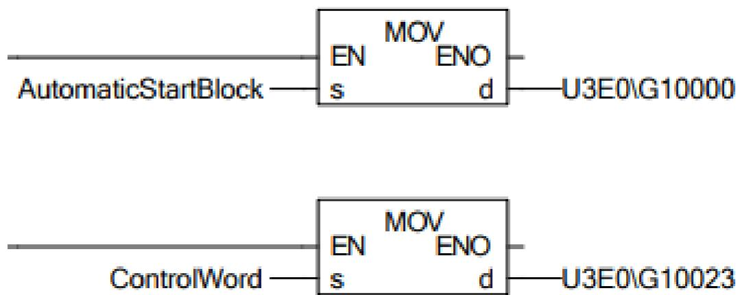
Slika 3.10 Slanje konačnih vrijednosti na robot modul
