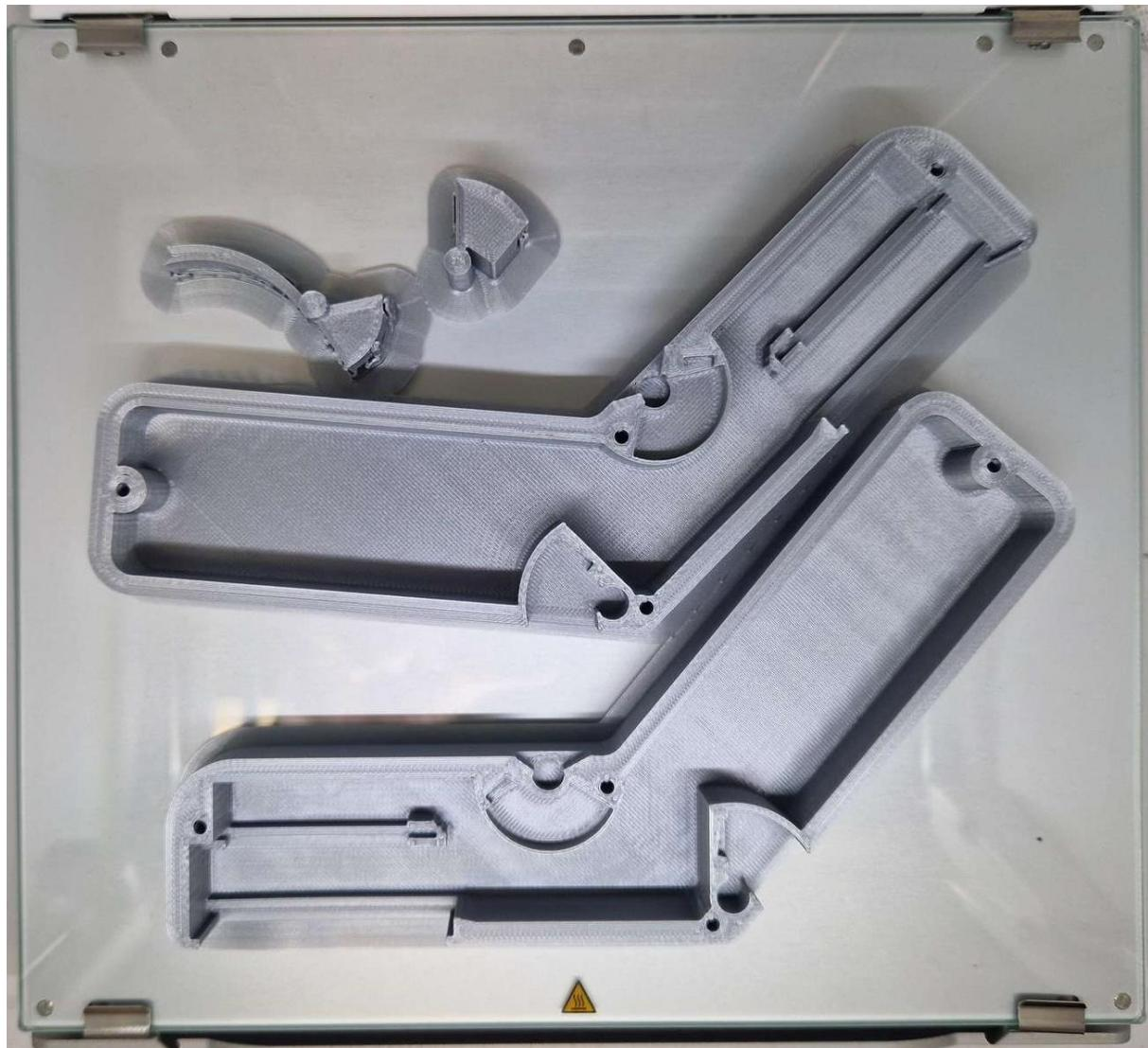
Slika 6.4. Radna ploča printerja nakon završetka printanja
