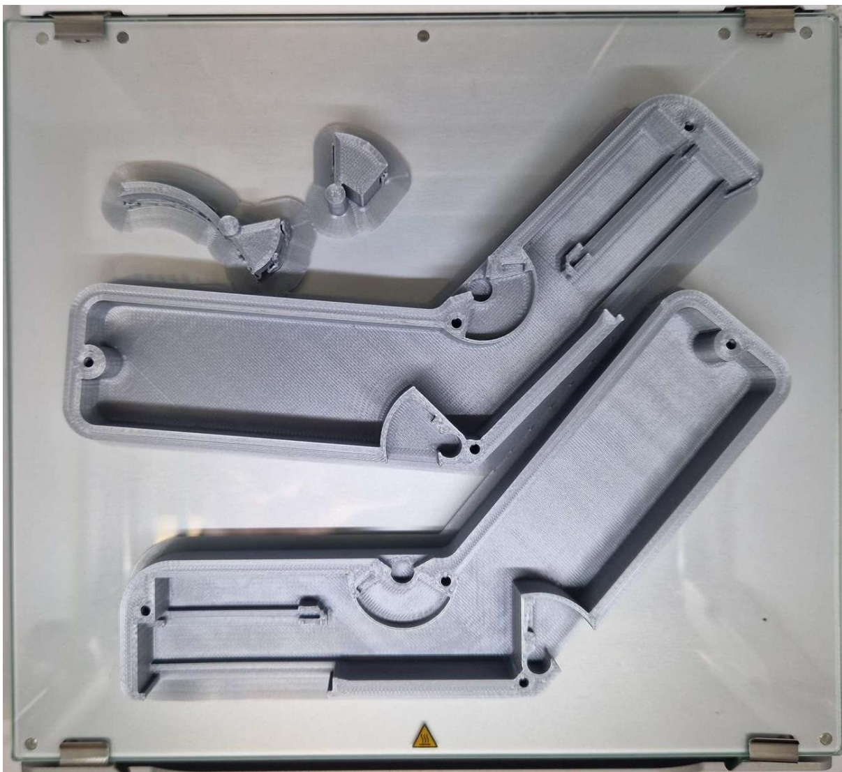
Slika 6.4. Radna ploča printera nakon završetka printanja
