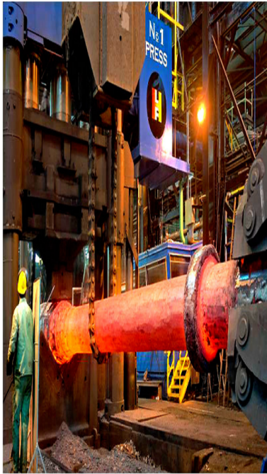
Slika 1.1- Proces slobodnoga kovanja osovine iz sirovca na hidrauličkoj presi [3]
