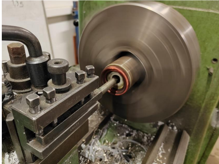
Slika 4.13-Završna obrada jezgre rotora
