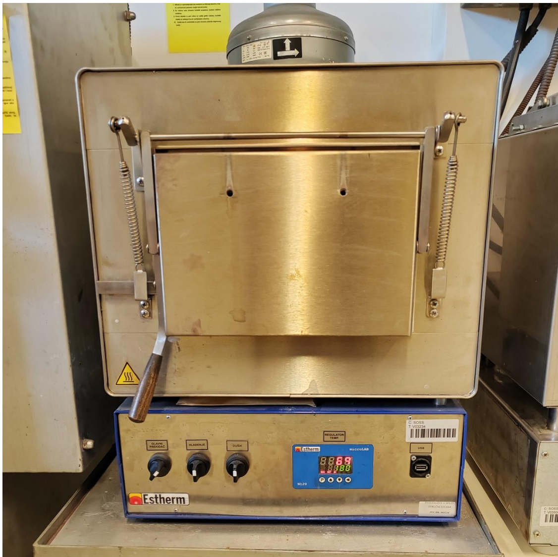
Slika 4.10-Nisko temperaturno popuštanje vratila
