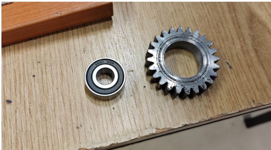
Slika 4.14-Zupčanik prilagođen za novi ležaj
