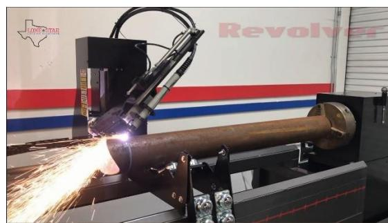
Slika 2.4 – CNC uređaj za obradu cijevi [4]
