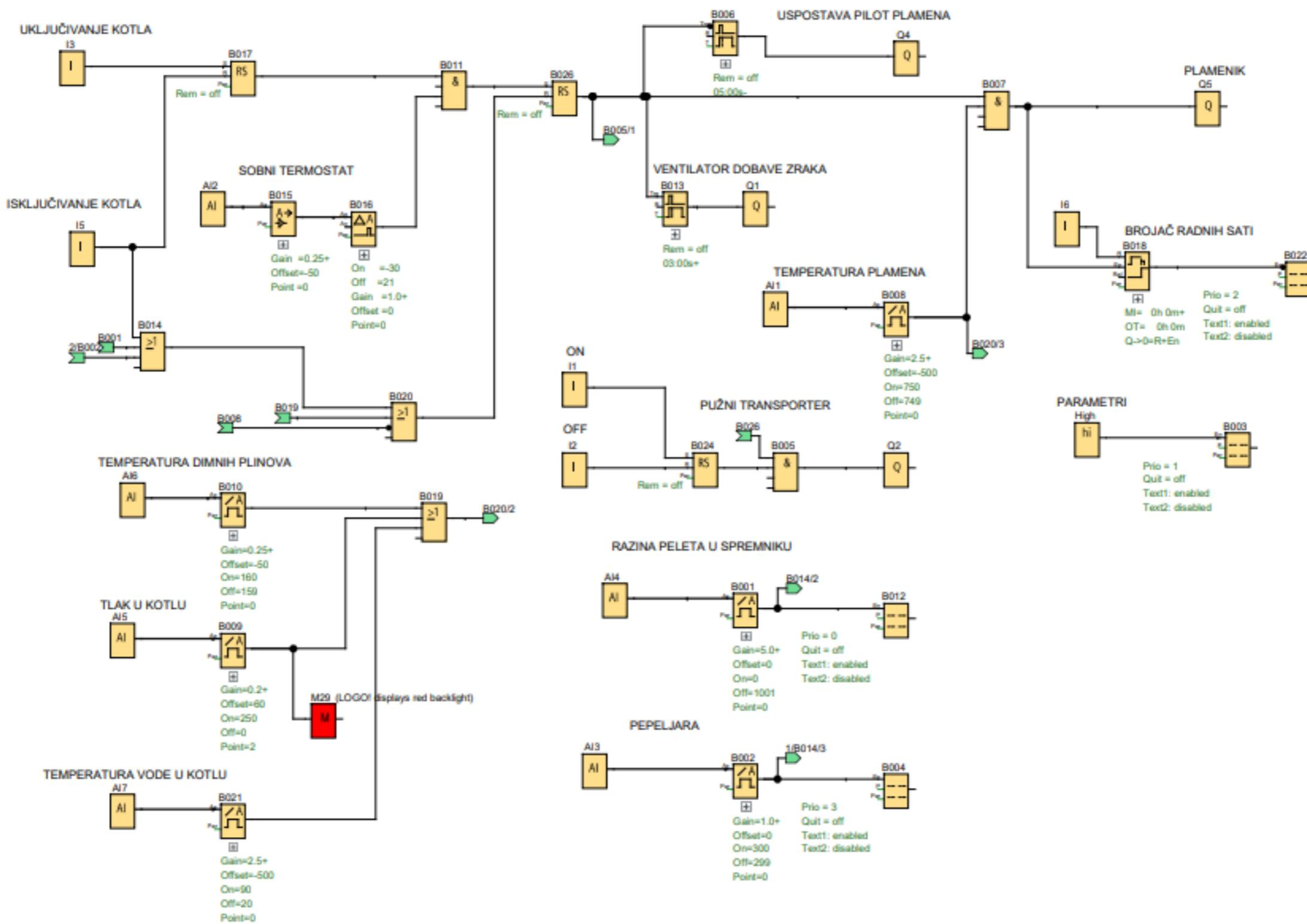
Slika 9.1 - Automatizacija kotla na pelet
