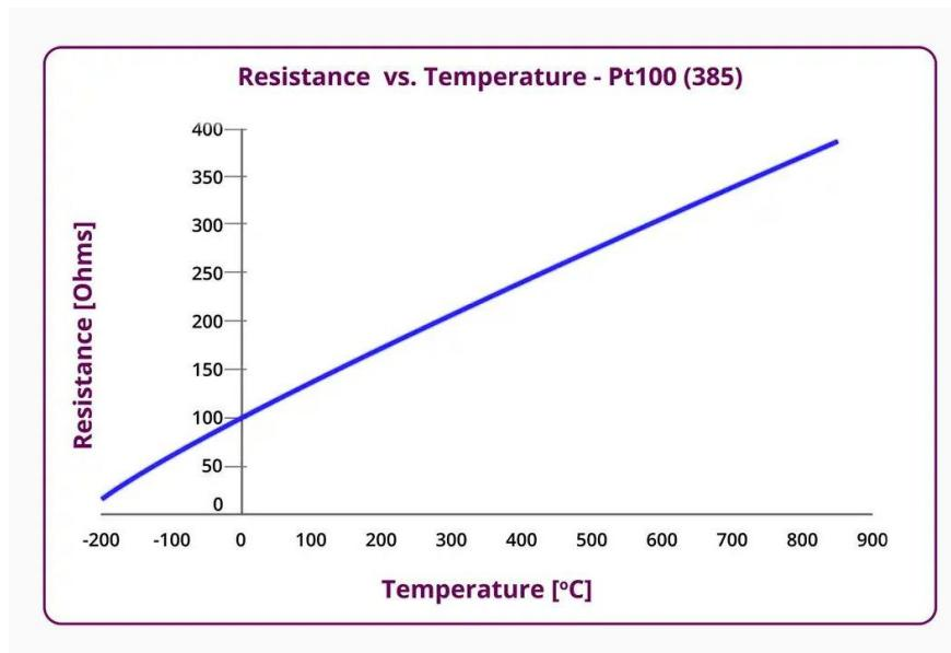
Slika 8.4 – Dijagram ovisnosti otpora o temperaturi [37]
