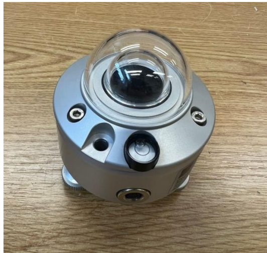
Slika 7.1. Piranometar SMP 10-A
