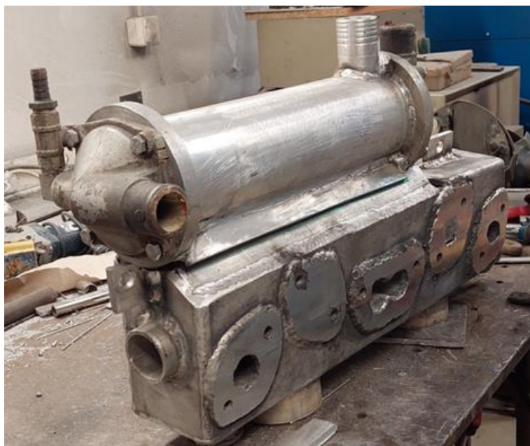
Slika 5.3 – Složeni komadi spremni za zavarivanje [12]
