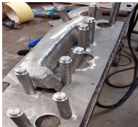
Slika 4.3 – Kanal ispušnih plinova [12]
