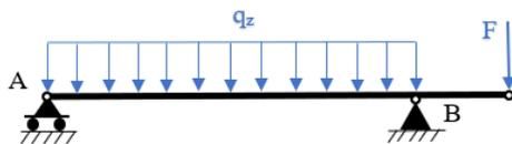
Slika 1.2 Nosač s jednim prepustom
