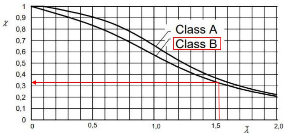
Zatim se vrši provjera zadovoljavanja uvjeta izvijanja tlačno opterećenog štapa:
