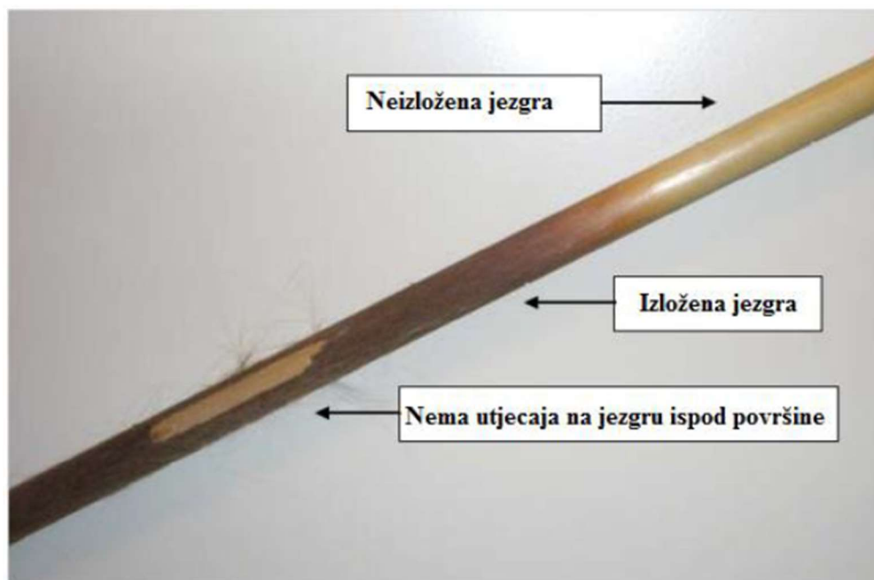
Slika 4.6. Kompozitna jezgra ACCC vodiča nakon izloženosti temperaturi od 220 °C 52 tjedna [10]
