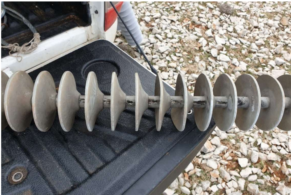
Slika 2.5. Proboj štapnog silikonskog izolatora
