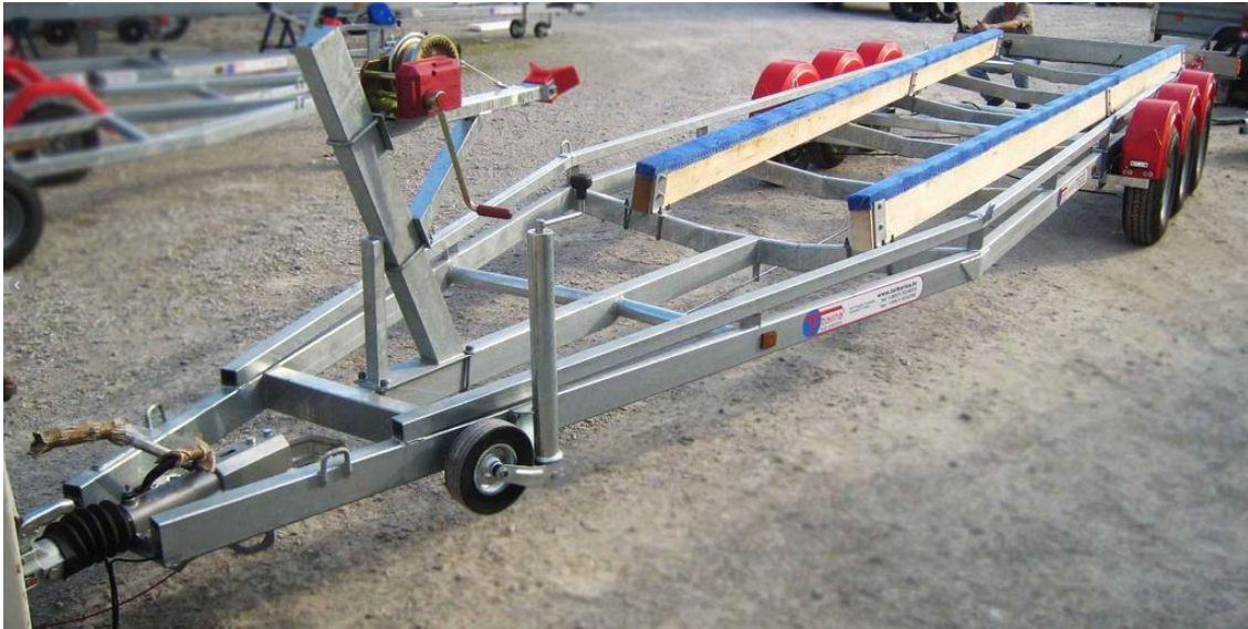
Slika 2.13 – Vruće pocinčana konstrukcija auto prikolice namijenjene prijevozu plovila. Profili izrađeni od konstrukcijskog čelika S235JR su međusobno spojeni zavarivanjem [20].
