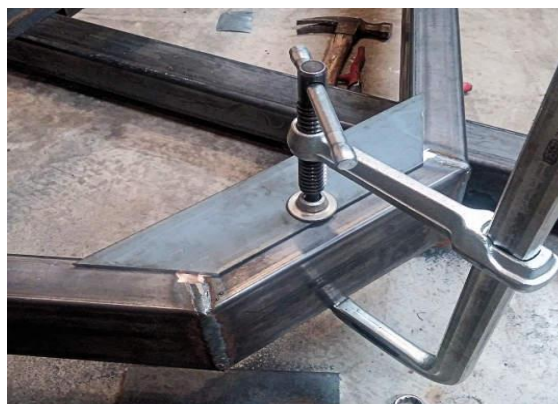
Slika 2.9 – Zavareni element za ukrućenje na kutovima konstrukcije [17].
