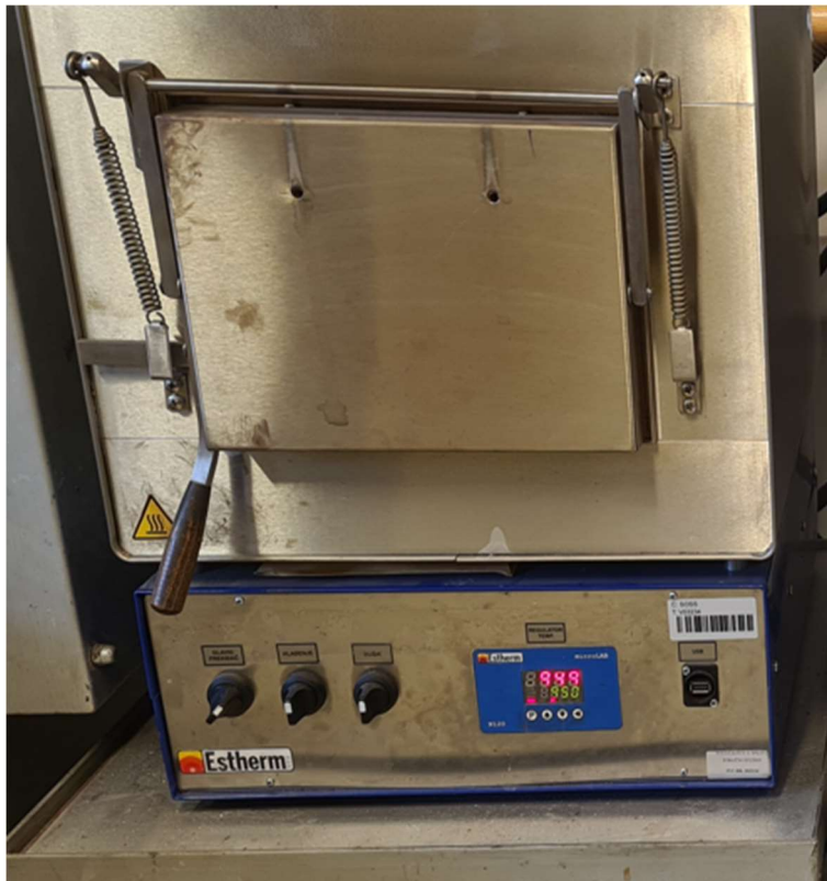
Slika 3. 3- Peć s prikazanom temperaturom austenitizacije 950°C
