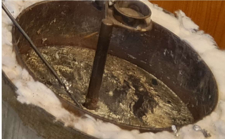
Slika 5. 3 – Izotermička kupka (rastaljeno olovo)
