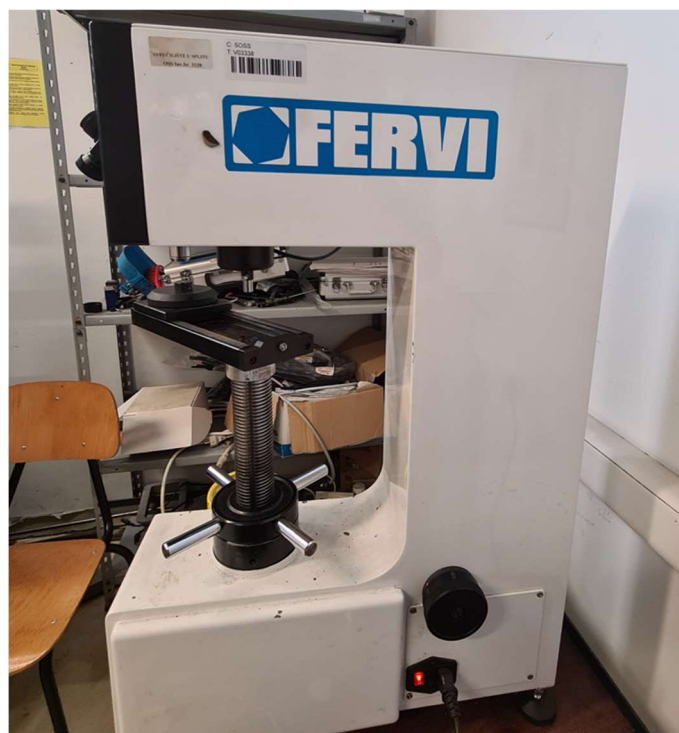
Slika 3. 5 – Uređaj za ispitivanje tvrdoće epruveta
