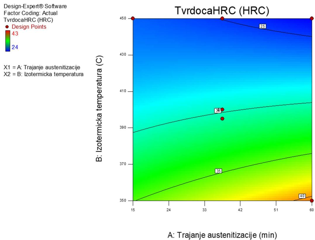
*Slika 6. 10 – Konturni dijagram ovisnosti tvrdoće po Rockwellu o parametrima toplinske obrade [4]*
