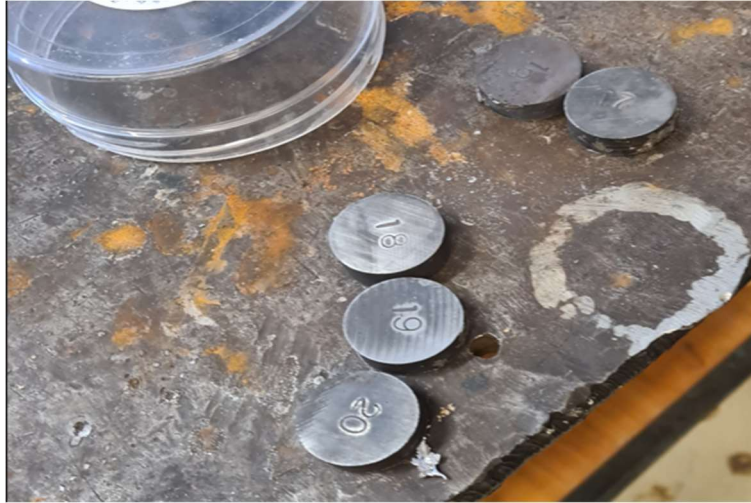
Slika 3.2 – Epruvete za prvi preliminarni pokus
