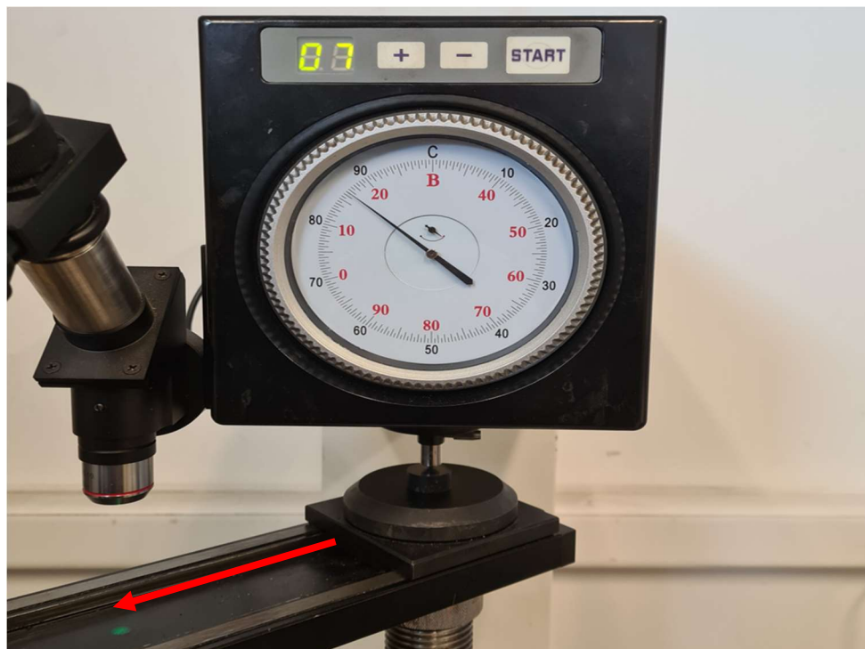
Slika 5. 8 – Smjer transliranja epruvete prema objektivu
