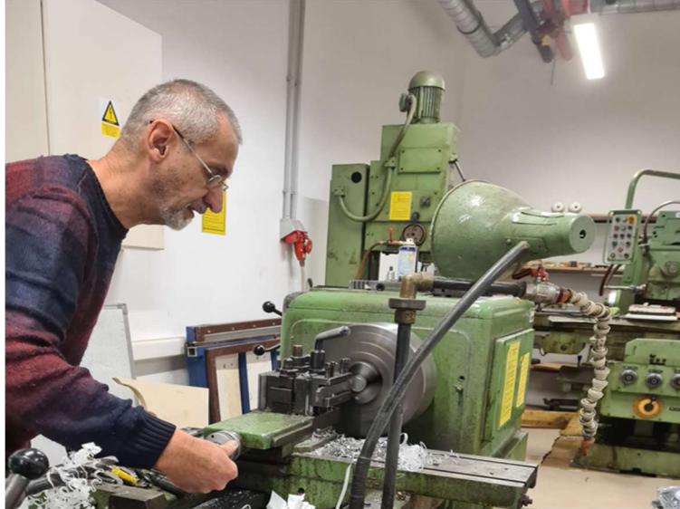
Slika 3. 9 – Obrada epruveta na tokarilici
