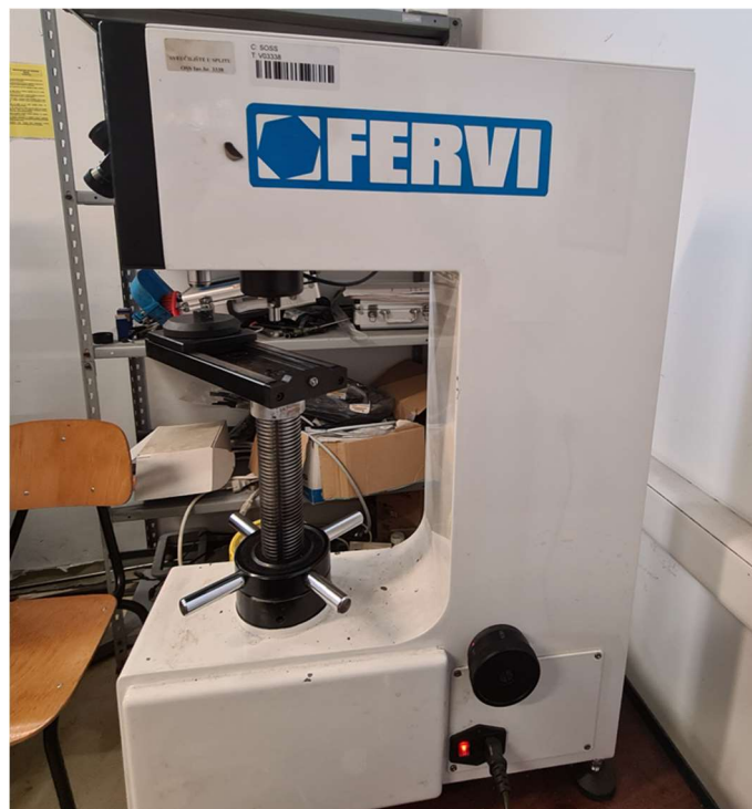
Slika 3. 5 – Uređaj za ispitivanje tvrdoće epruveta
