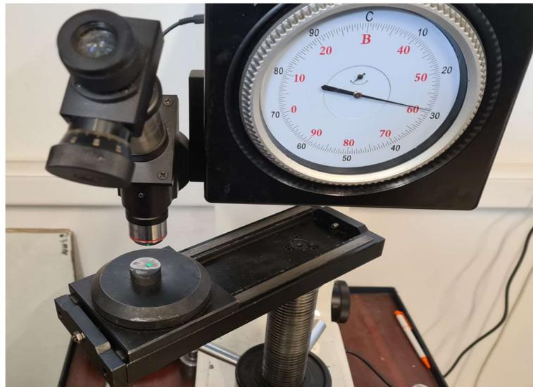
Slika 5.9 – Epruveta u položaju za mjerjenje otiska
