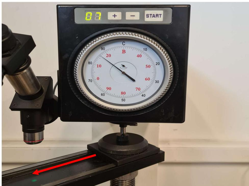
Slika 5. 8 – Smjer translatiranja epruvete prema objektivu
