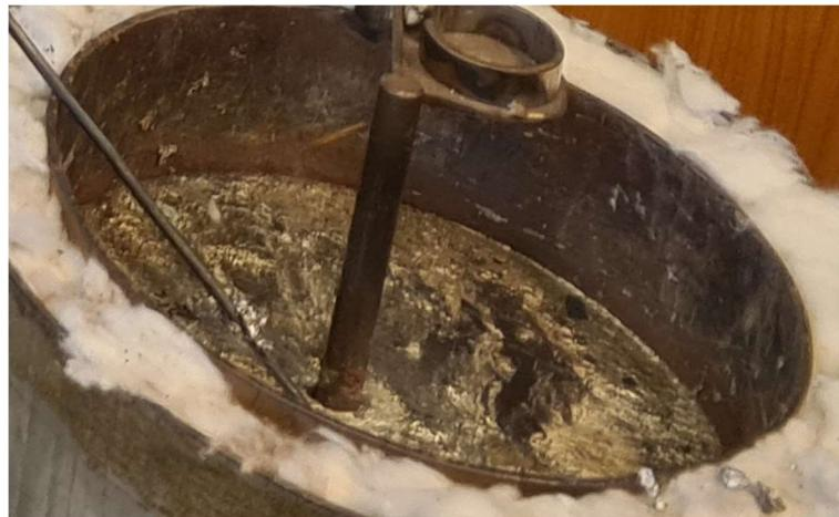
Slika 5. 3 – Izotermička kupka (rastaljeno olovo)
