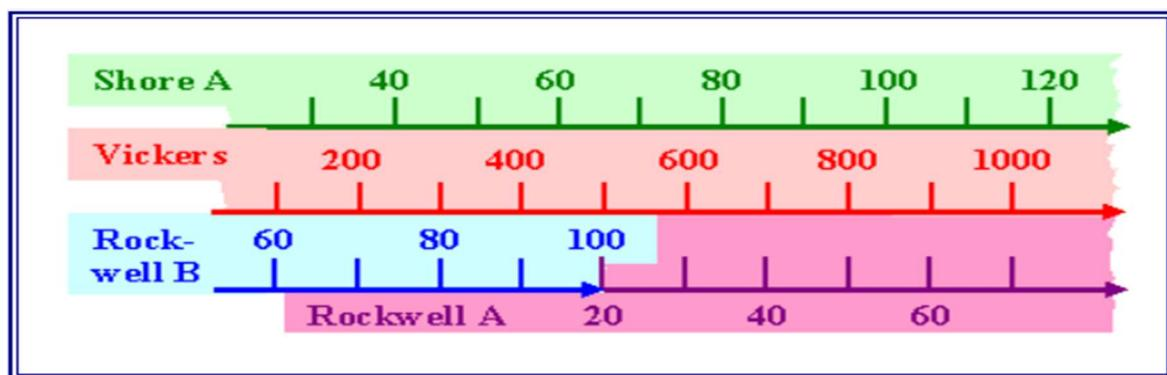
Slika 5. 12– Usporedna tablica različitih standarda za mjerjenje tvrdoće [6]
