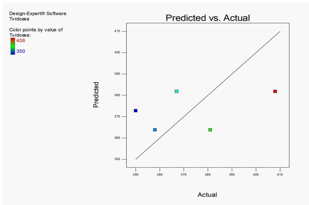
Slika 3. 6 – Očekivani i stvarni rezultati tvrdoće epruveta
