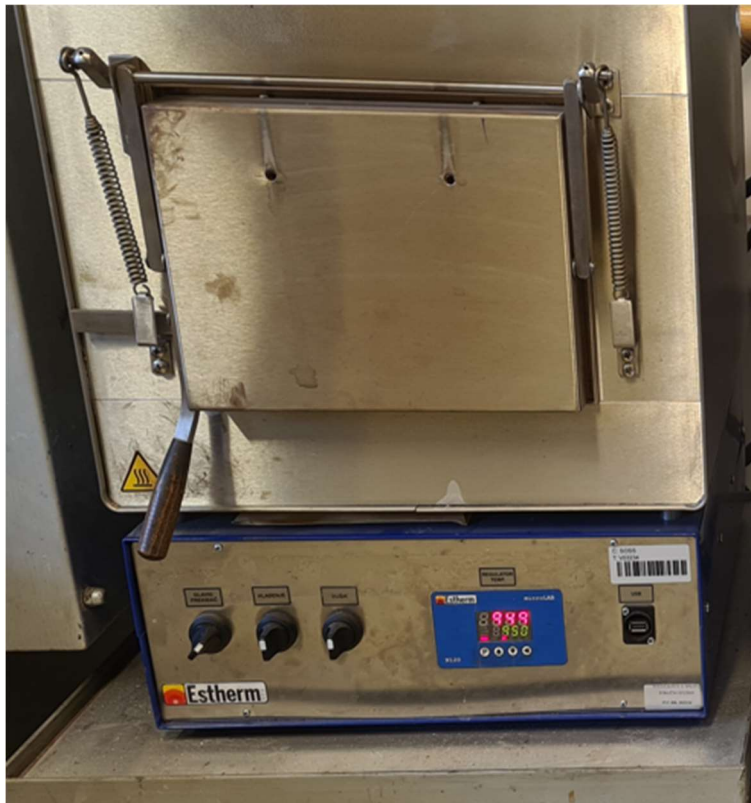
Slika 3. 3- Peć s prikazanom temperaturom austenitizacije 950°C
