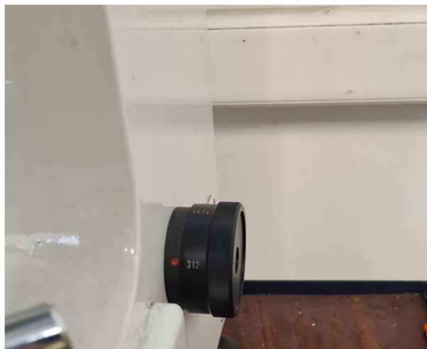
Slika 5. 4 – Izbor sile utiskivanja penetratora (30kp)
