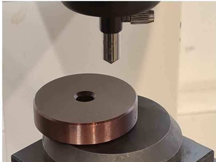
Slika 5. 13 – Etalon za provjeru točnosti mjernog uređaja
