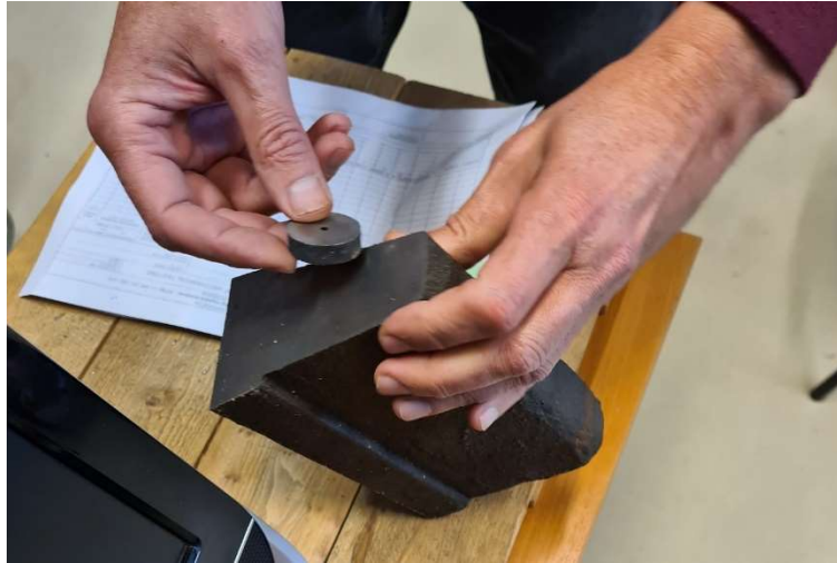
Slika 3. 1- Odljevak žilavog lijeva za izradu epruveta
