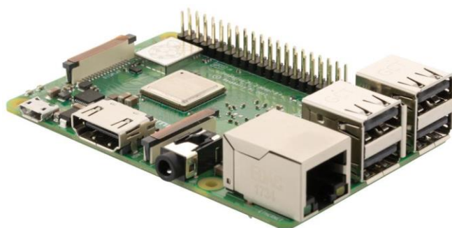
Slika 4.7 Raspberyy Pi 3 B+
