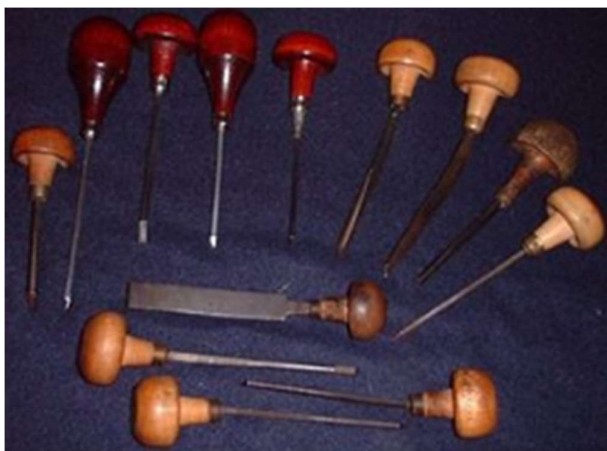
Slika 1.7 - Asortiman ručnog alata za graviranje [3]
