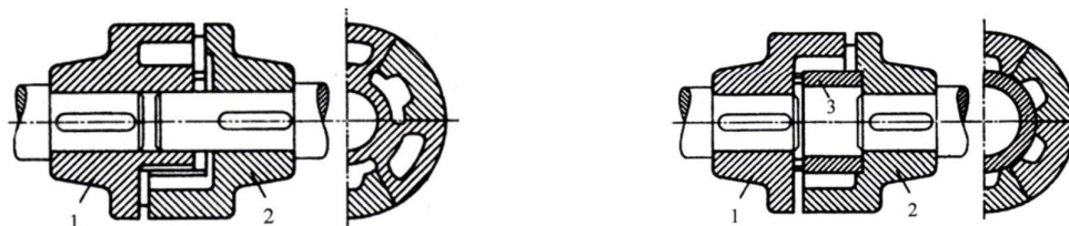
Slika 3.27 - Kandžasta dvodijelna spojka [19] Slika 3.28 - Kandžasta trodijelna spojka[20]
