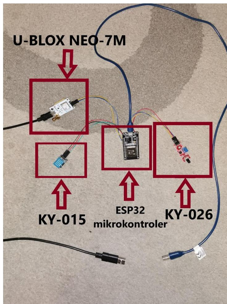
Slika 7 - Mikrokontroler i dodaci - prototip
