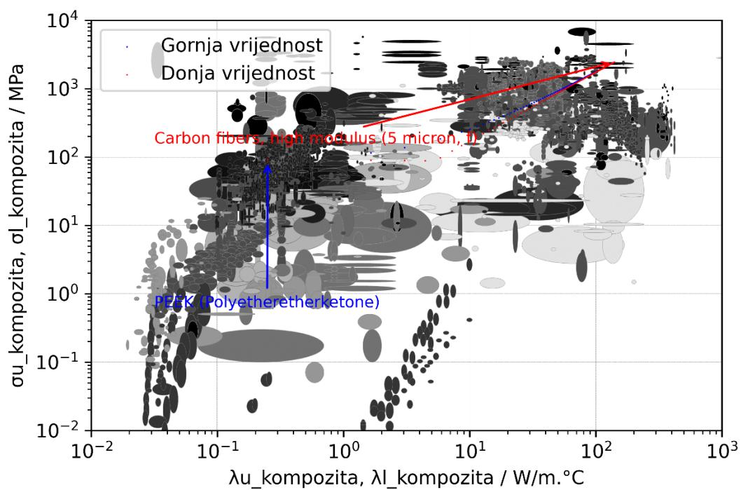
Slika 4.1 – Dijagram svojstava materijala „Toplinska vodljivost – vlačna čvrstoća“ [2]
