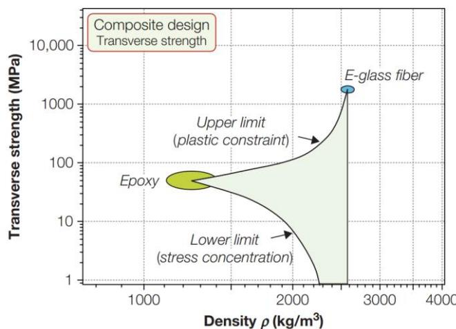
Slika 1.3 - Dijagram materijala Poprečna čvrstoća – gustoća za kompozite [1]
