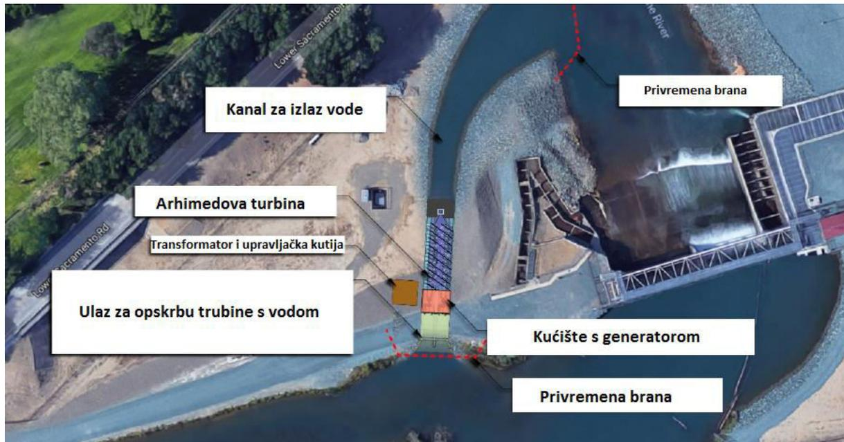
Slika 8.2 – Izvedba s kraćim dotokom vode i s iskopima za ispuštanje vode [9]
