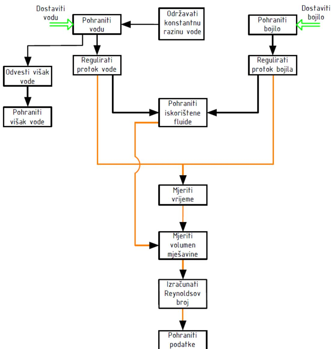
Slika 3.1 – Funkcionalna struktura modela Reynoldsovog eksperimenta
