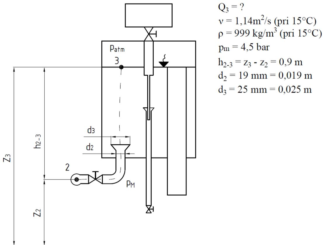
Slika 4.4 – Shematski prikaz modela Reynoldsovog eksperimenta – Dovodna cijev
