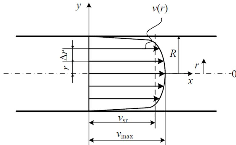
Slika 2.4 – Profil brzine pri turbulentnom strujanju [5]
