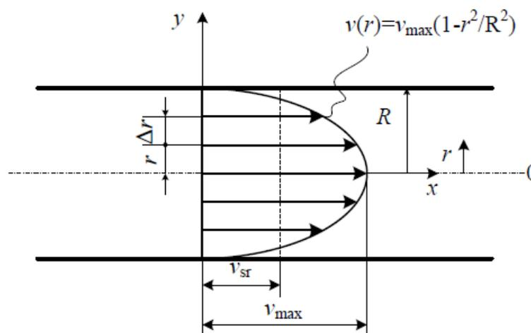
Slika 2.3 – Profil brzine pri laminarnom strujanju [5]
