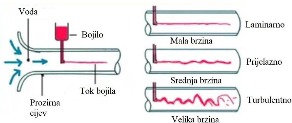
Slika 2.2 – Vrsta strujanja u odnosu na brzinu protoka [4]
