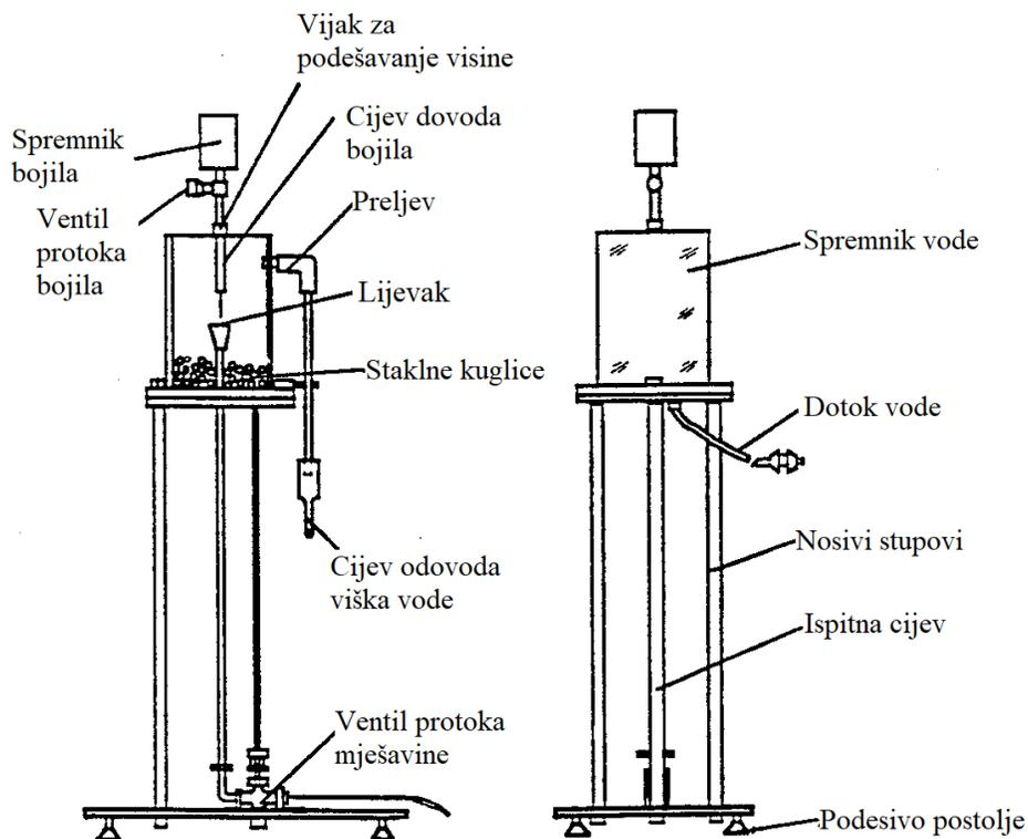
Slika 3.2 – Shematski izgled vertikalnog modela Reynoldsovog eksperimenta [6]
