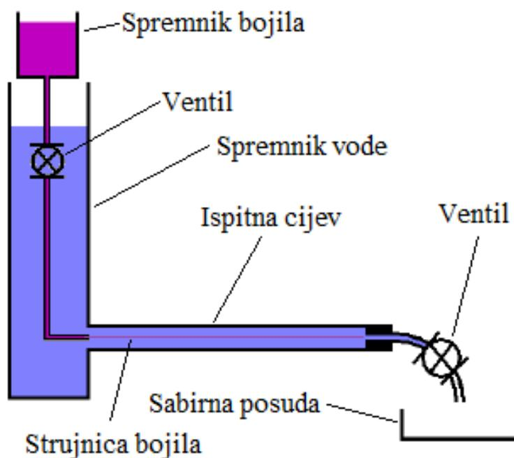
Slika 2.1 – Shematski prikaz Reynoldsovog eksperimenta [2]
