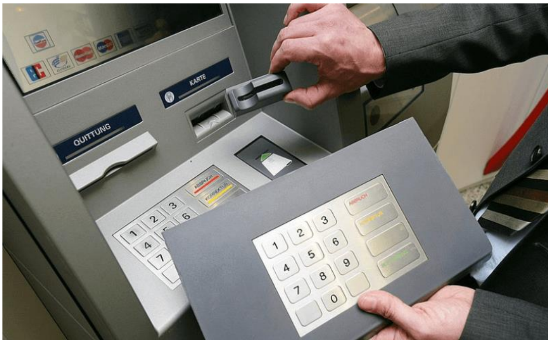
Slika 14. Lažna tipkovnica na bankomatima
