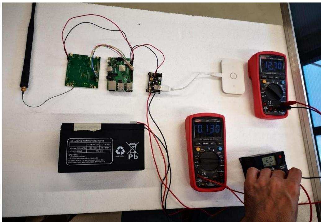
Slika 6. 2. Mjerjenje struje i napona na sustavu
