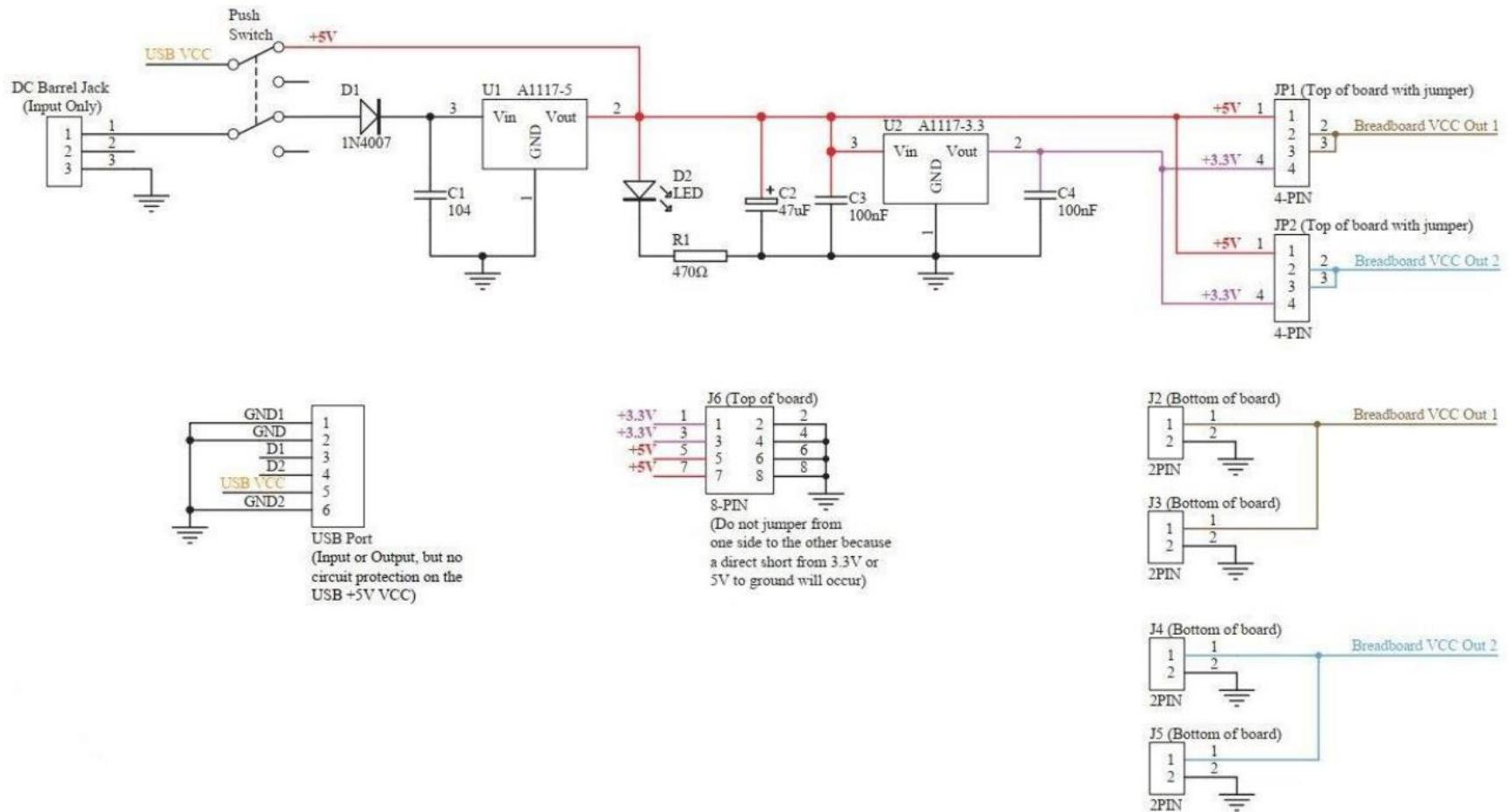
Slika 5.3. 4. Shematski prikaz cijelog modula MB102
