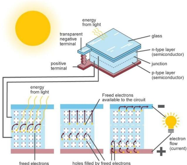
Slika 4. 1. Princip rada solarne ćelije [7]
