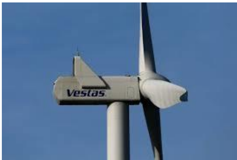
Slika 2. Vjetroagregat marke Vestas V112 [5]
