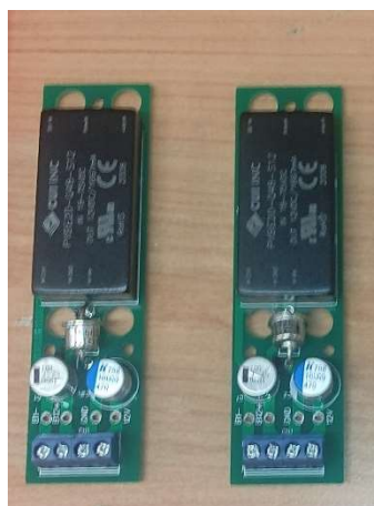
Slika 4.7. Pločice napajanja nakon izrade
