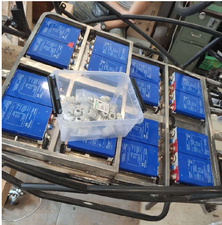
Slika 2.2. Prikaz baterijskog sustava u montaži
