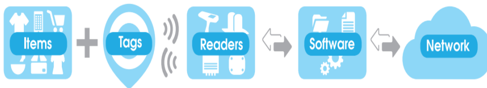
Slika 9. RAIN RFID princip rada
