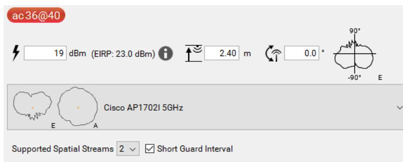
Slika 34: Podešavanje snage prenošenja signala za 5 GHz
