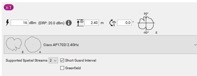
Slika 33: Podešavanje snage prenošenja signala za 2,4 GHz
