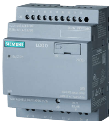
Slika 2.1 Siemens LOGO!8 PLC kontroler [1]
