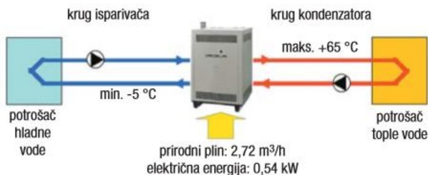
Slika 3.12 - Režim rada uređaja GAHP-W [2]
