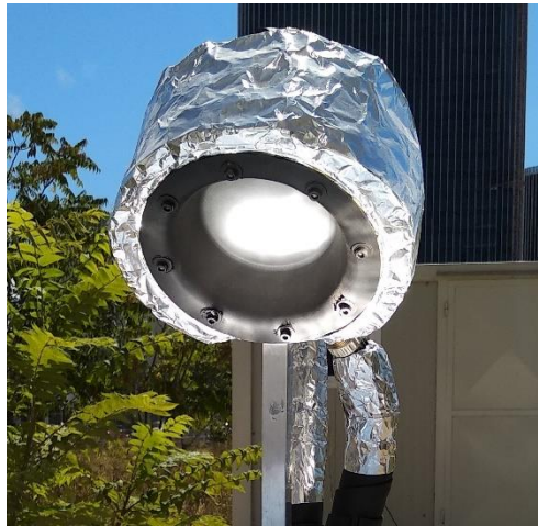
Slika 3.5.- Fokusiranje sunčevog zračenja na grijaču
