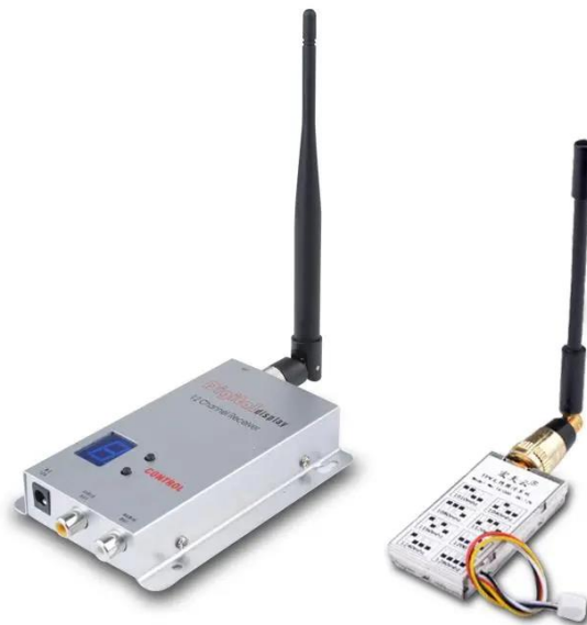
Slika 10. Primjer predajnika desno i prijammnika lijevo [24]
