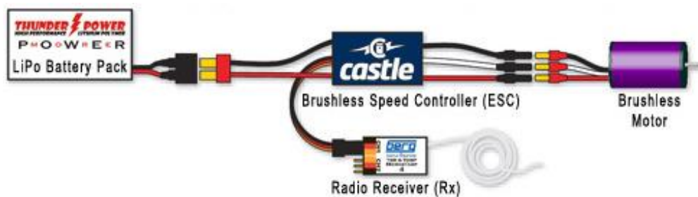
Slika 4. Prikaz kontrolera brzine sa sastavnim dijelovima. [2]
