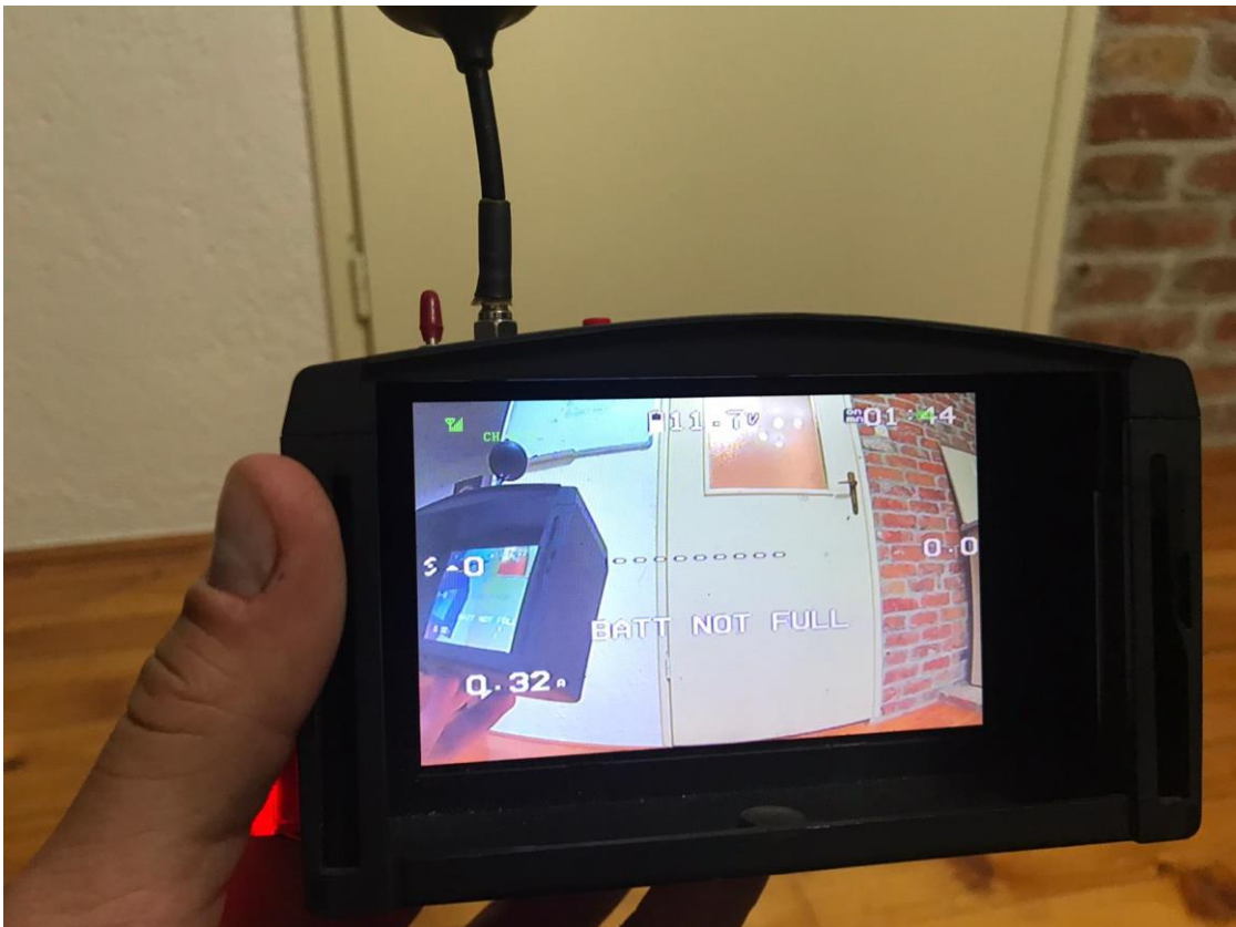
Slika 29. Video veza s osnovnim prikazom podataka na ekranu
