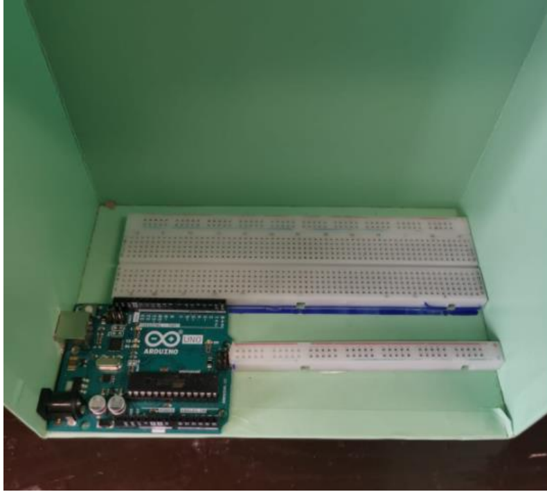
Slika 7.1 – Postavljanje Arduina u kućište
