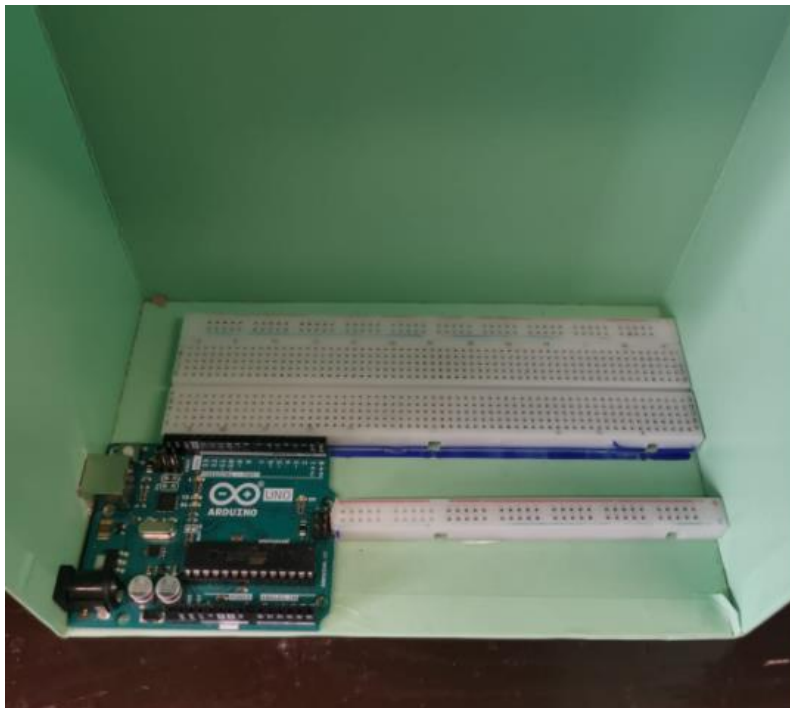
Slika 7.1 – Postavljanje Arduina u kućište
