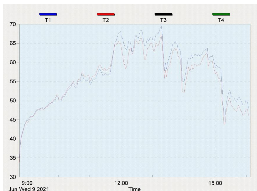
Slika 4.7 - Grafički prikaz promjene temperature T1 i T2 na površini FN modula
