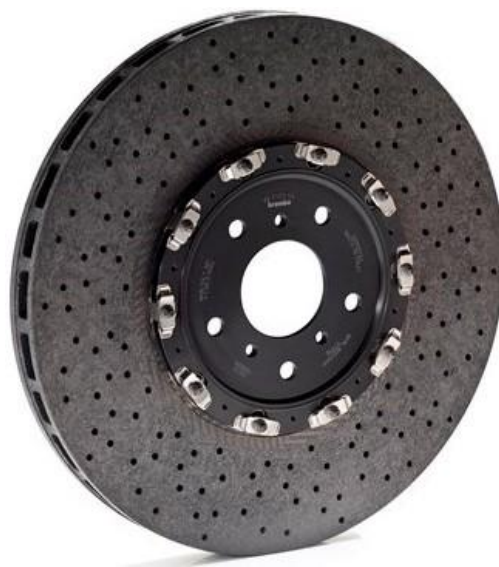
Slika 2.2 - Kočioni disk od kompozita keramičke matrice [13]
