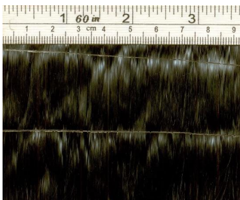
Slika 5.18 - Jednoosno usmjerena tkanina od ugljičnih vlakana [35]
