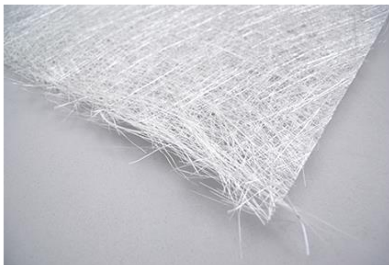
Slika 3.5 - Mat od staklenih vlakana [21]
