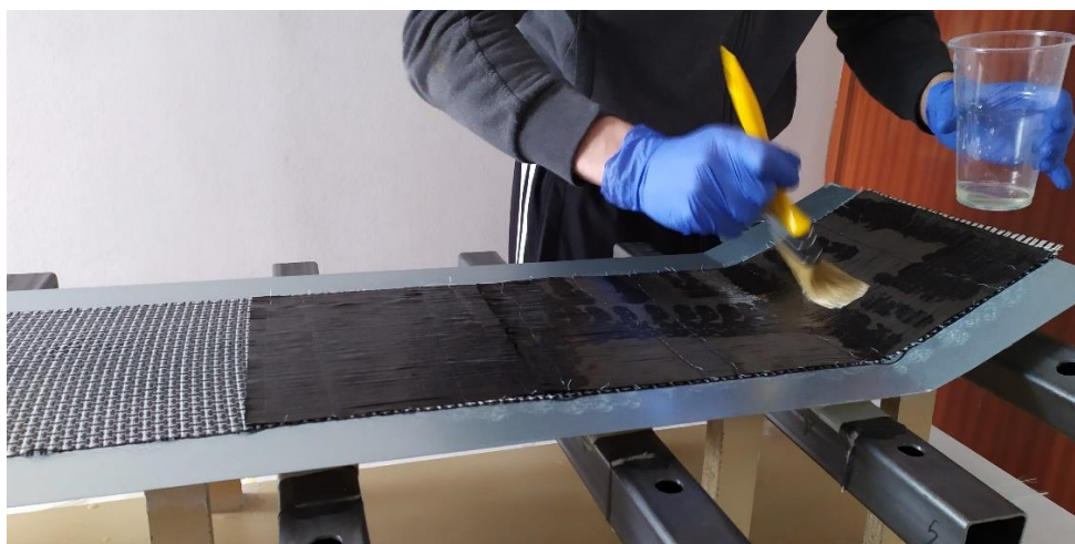
Slika 5.23 - Ručno laminiranje tkanina od ugljičnih i Innegra™ S vlakana
