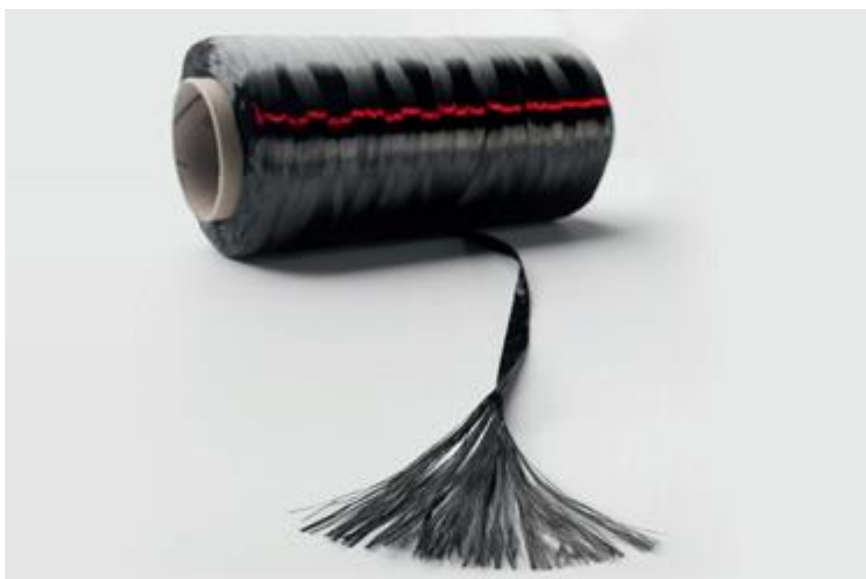
Slika 3.3 - Namotana ugljična vlakna na špulu (tow) [19]
