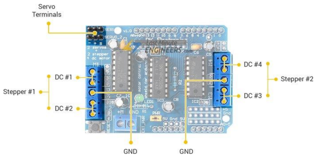
Slika 4.22. Raspored izlaznih stezaljki za priključak motora [35]
