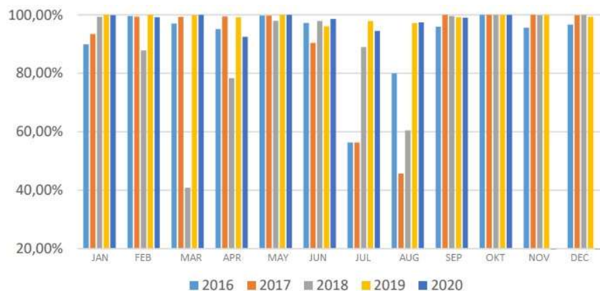
Slika 4.2. Mjesečni rad TS Mostar 4 (400 kV) pri povišenim naponima tijekom 5 godina
