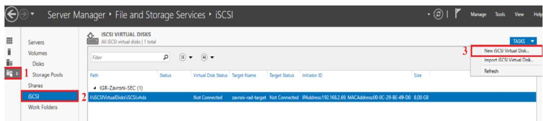
Slika 5: Izrada iSCSI virtualnog diska
